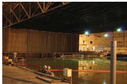
照片 1 水槽上方及左側方配置黑幕
