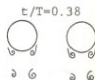
圖10 T=8.0\text{sec} , H=0.8\text{cm} (K.C.)_m=5.3 Rem=520 圓柱距離五倍直徑
