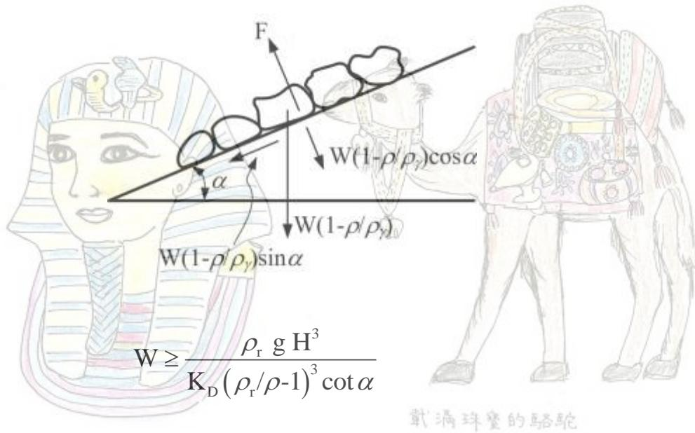
上式為 Hudson 將 Iribarren 推導出的安定公式，經多次試驗改寫而成，稱為 Hudson 公式。 $K_D$  為無因次穩定係數，依被覆材及破壞率等決定的係數， $K_D$  值大時所需石材重量較小，拋石約在 2.8~4.3 間，混凝土消波塊約在 6.6~13.6 間。
