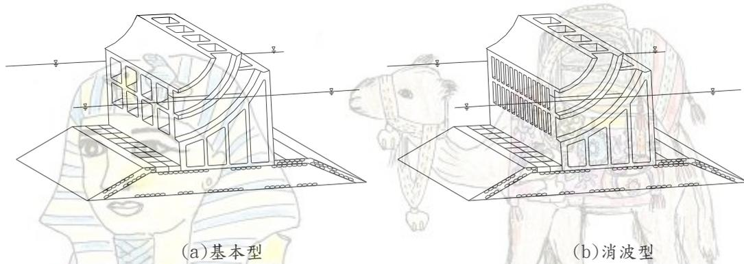
多重中空沉箱堤構想源起於上方斜面沉箱堤。如圖所示，在沉箱上部設置有多段彎曲斜面壁。圖 (a)所示，前面開孔部完全開放之構造，稱為基本型。圖 (b)所示，設置適當比率之開孔透過壁，以減輕反射波及傳遞波者稱為消波型。
