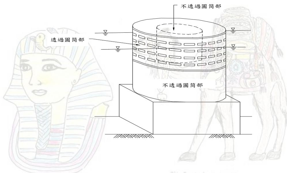
雙圓筒沉箱堤如圖所示，於基礎沉箱上，配置雙圓筒結構物，外側圓筒壁上部加以適當的開孔，與不透水內側圓筒間構成消波室以達減波效果。
