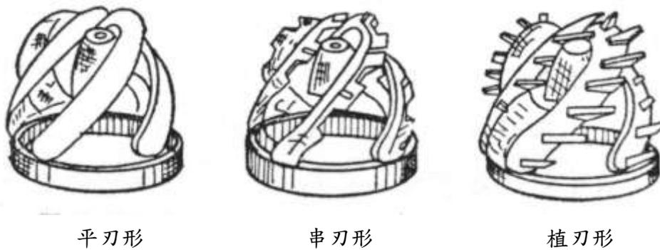
浚深船船首配置絞刀吸泥管(ladder)從桁架以鋼索垂吊，可調整其上下角度，其前端安裝絞刀用以挖掘海底地盤。船尾配置2根圓柱形棒錨(spud)用以固定船體及移動船體。
