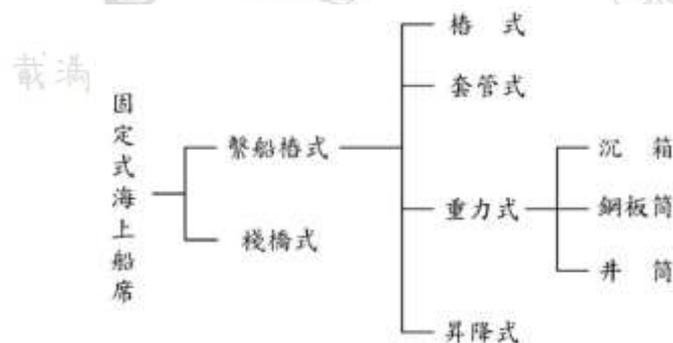
固定式海上船席是指結構基礎固定於海底者，分成為將靠岸設施、繫船設施及裝卸設施集中配置於同一甲板的棧橋式及各自獨立的繫船樁式。兩方式均在中央配置裝卸設施、兩側配置靠岸設施、最外側為繫船設施。繫船樁式配置稱為裝卸平台、靠岸樁及繫船樁的獨立結構。海上船席至陸上基地的連結，可利用棧架(trestle)或海底管線，但是散貨只能採用棧架方式。
