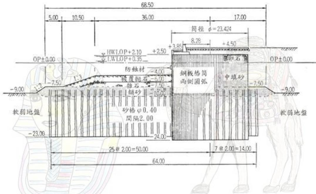
由於填海護岸大多構築於軟弱地盤上，必要進行地盤改良，最傳統簡單工法是挖基、換置工法，然而因大量挖基土的處理問題、海水污濁及能否確保大量換置材等，施工上、環境上有許多困難。軟弱地盤改良工法逐漸被砂樁法、砂壓樁法取代，但是必要大量砂的問題依然存在，因此深層混合處理法會是今後有力工法之一。
