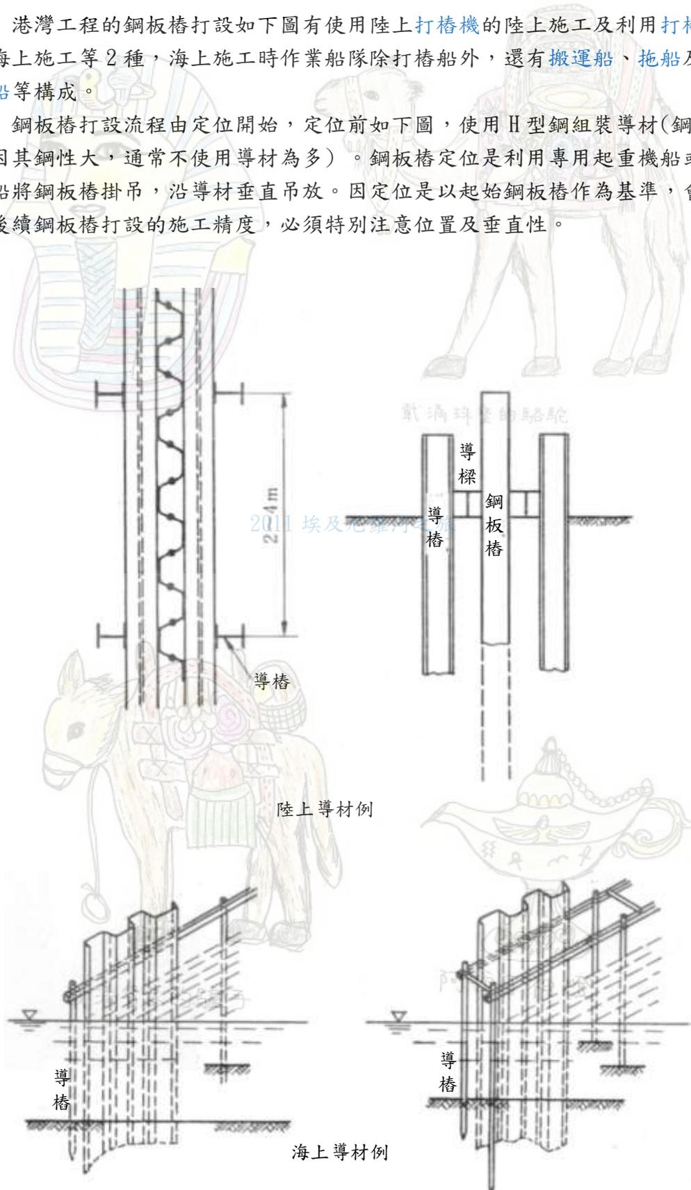
利用起重機船(打樁船)為防止傾斜或下陷，如下圖，先將 20 片左右的鋼板樁就定位後，再進行打設（稱為屏風打設）時，揚程需大於單片打設者。鋼板樁搬運通常利用駁船，為作業連續，一般在工地現場待命的駁船上備料 2 日份。
